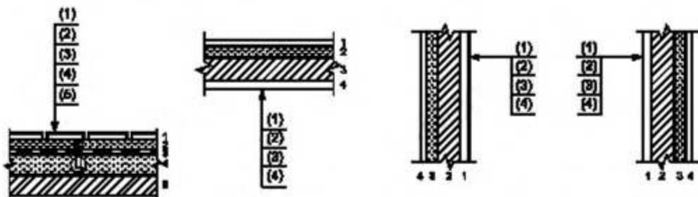
**Примечание** — Цифры условно обозначены последовательность расположения слоев конструкций и надписей на полках линий-выносок.
